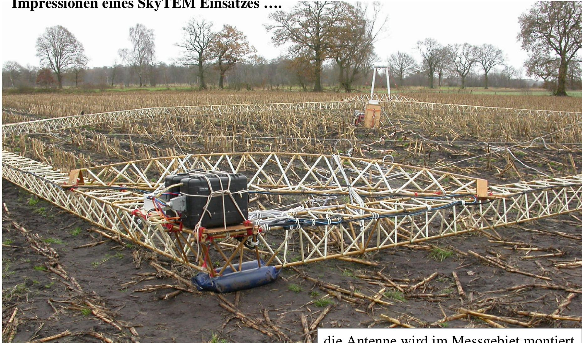
die Antenne wird im Messgebiet montiert
