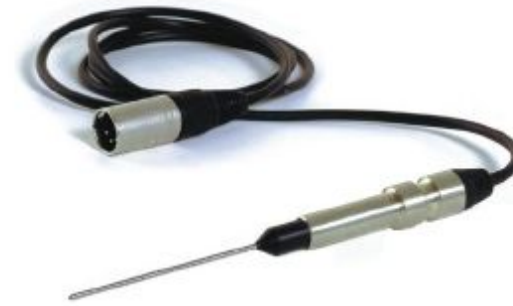
Bild 26: VLQ-Sonde für die Messung der Wärmeleitfähigkeit (HONARMAND 2002)
