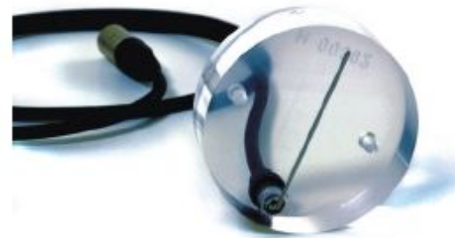
Bild 24: HLQ-Sonde für die Messung der Wärmeleitfähigkeit (HONARMAND 2002)
