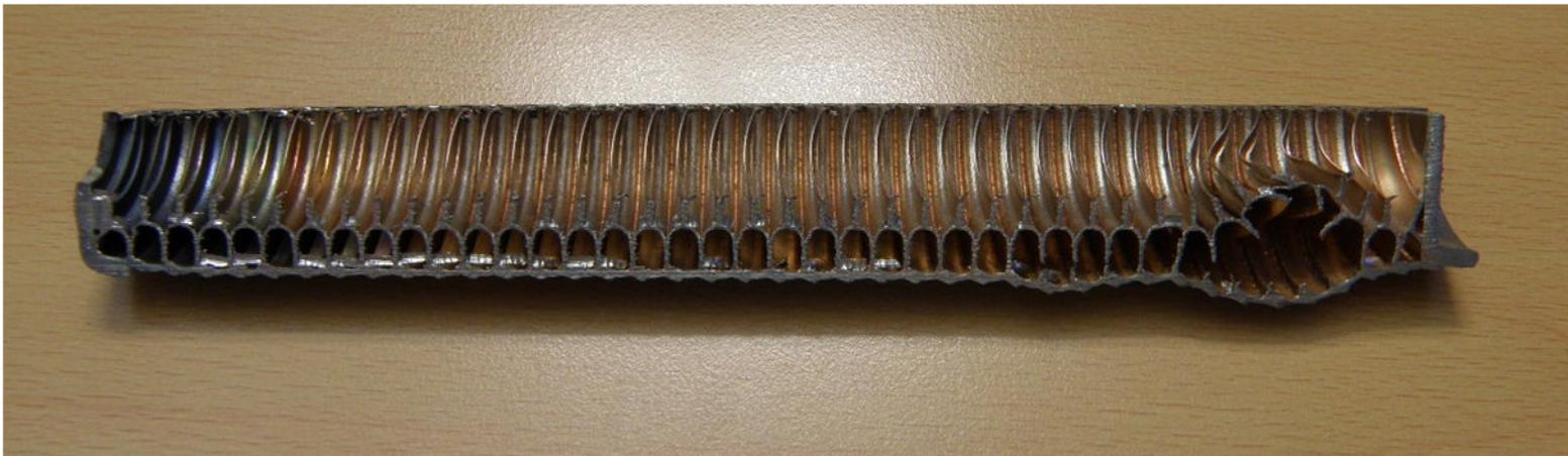
Frostschaden auf der Primärkreisseite eines Verdampfers
