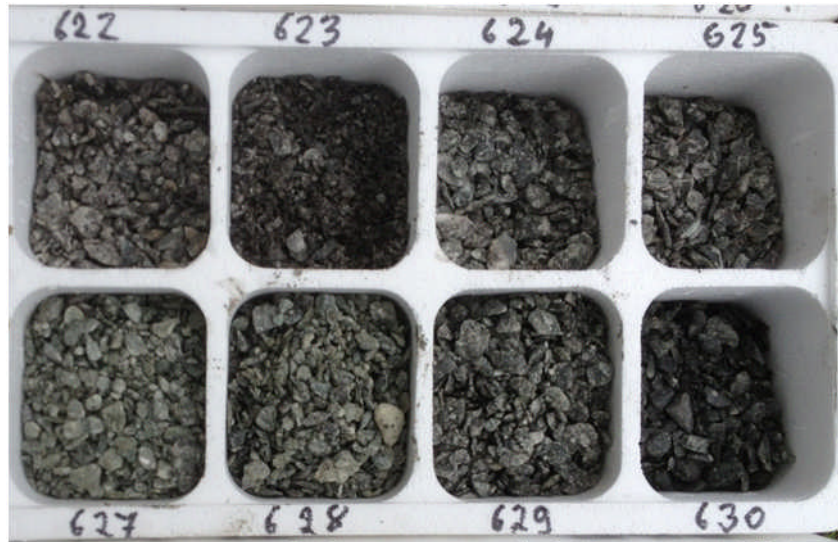
Bohrklein (Cuttings) aus der Spülung
