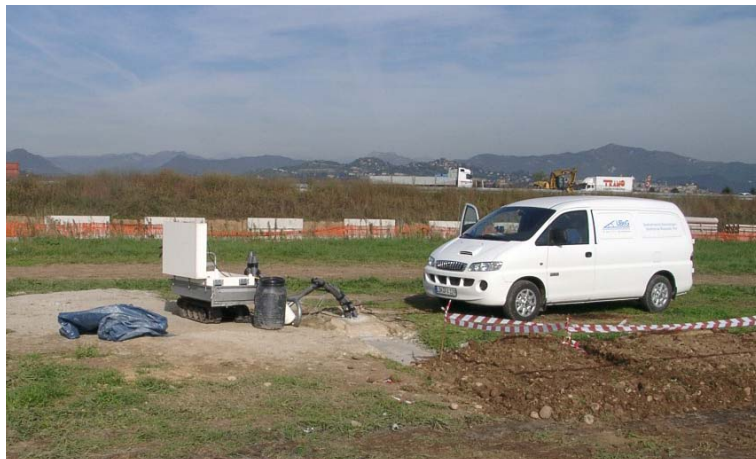
Thermal Response Test zur Bestimmung der Gesteinsparameter
